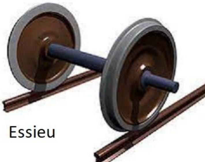
Essieu : ensemble mécanique constitué de deux roues et d'un axe transversal.
